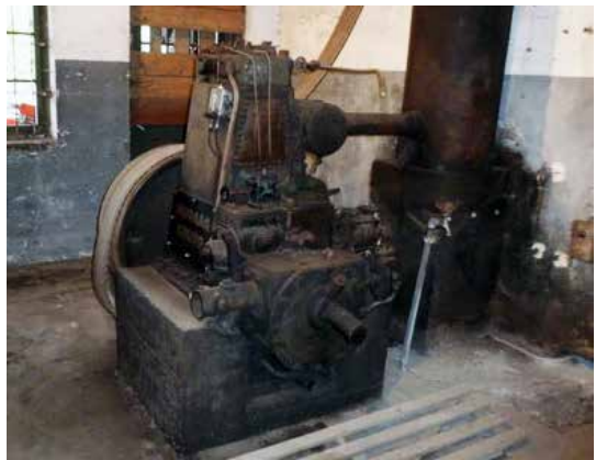
MODAAG Motor 2 Zylinder 2-Takt Dieselmotor. Gestartet wird der Motor mit Pressluft. Offenes Kühlwassersystem (Schiffsmotor)
