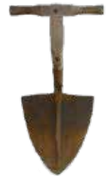
Grabscheit zum Abtragen der Bewuchsschicht aus Heidekraut, Wollgras und anderen niederen Pflanzen.
